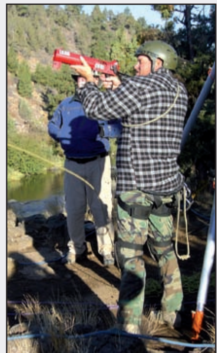
Ilmanpaineella toimivan ResQmax-aseella voidaan ampua köysi jopa 150 metrin päähän.
